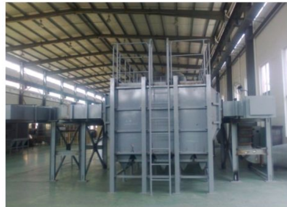
电除尘器流场物模试验平台
