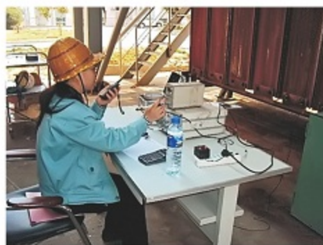
案例 内蒙古某电厂600MW机组配套电除尘器厂内及现场振打加速度试验
