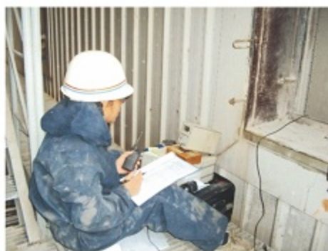
案例 内蒙古某电厂600MW机组配套电除尘器厂内及现场振打加速度试验
