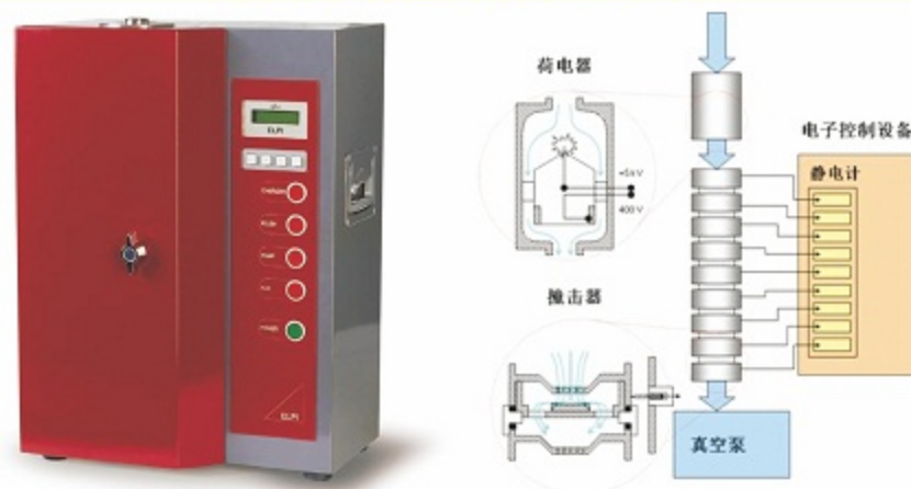
ELPI主机及结构示意图
